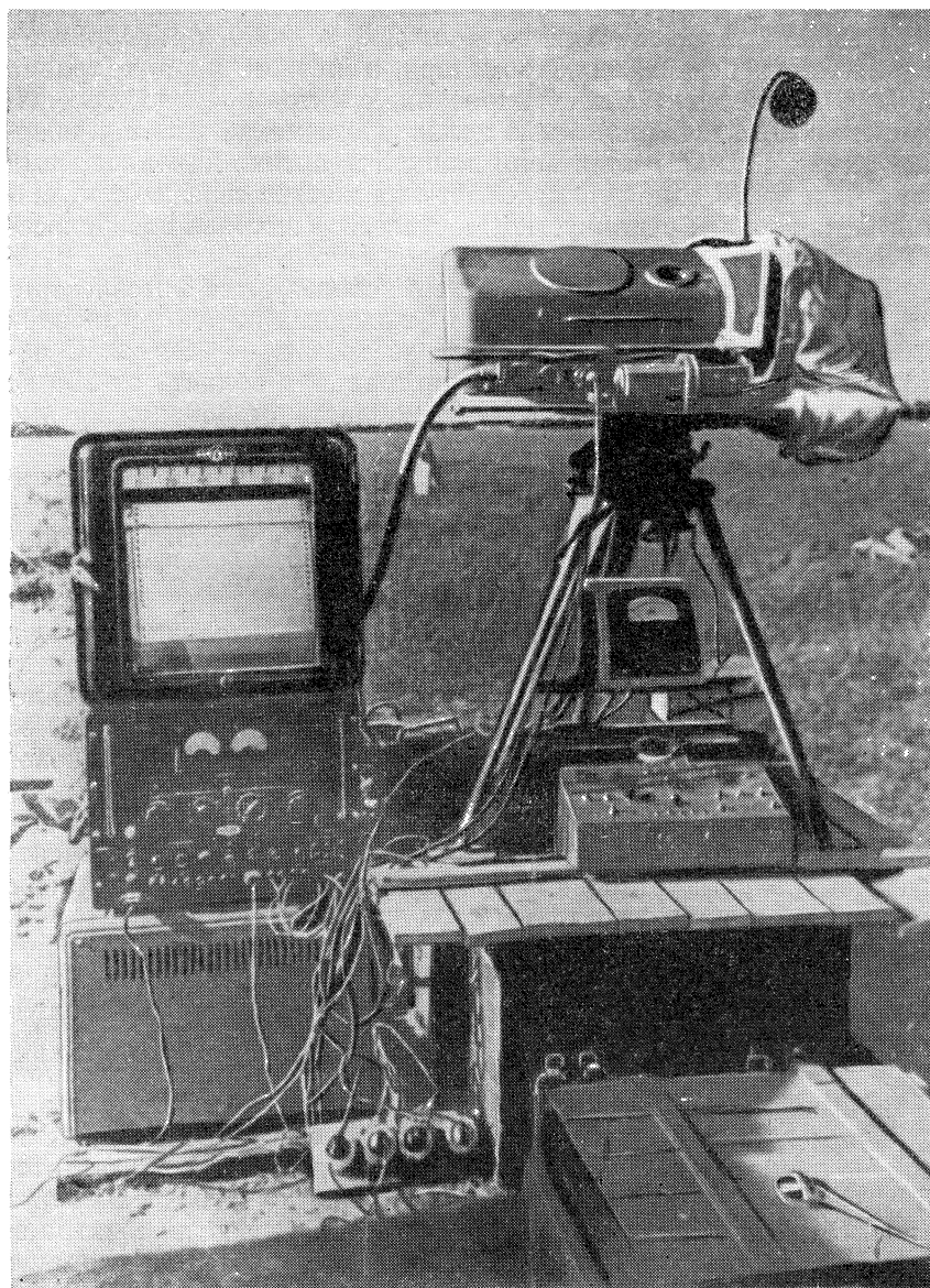
Рис. 15. Спектрофотометр для измерений потоков суммарной и рассеянной радиации.
